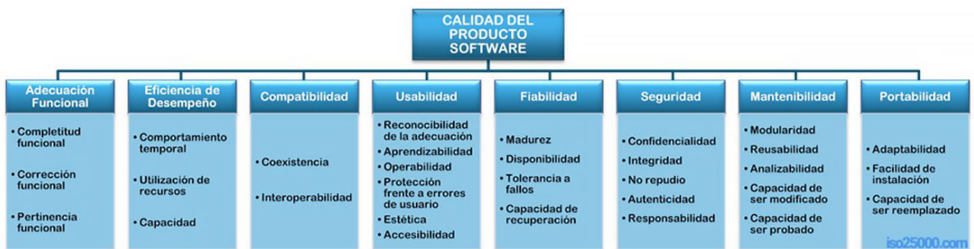
FIGURA 1. Características del modelo de calidad de softwares (Comisión de proyecto ISO/IEC, 2011 a )
